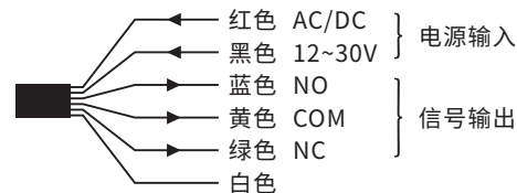
输入输出接线
