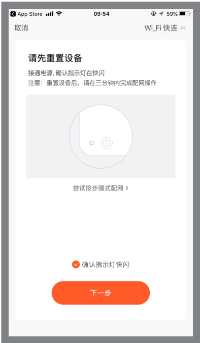
第5步：长按接收器学习按键约10秒，WIFI绿色指示灯闪，勾选涂鸦智能界面“确认指示灯快闪”，点击“下一步”。
